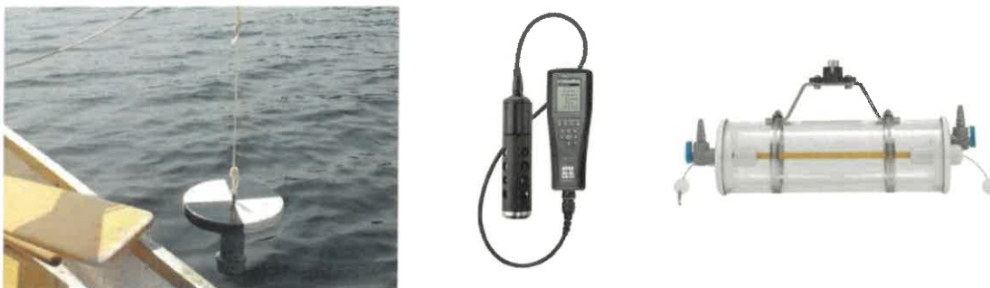
Figure 6 Instruments utilisés lors de l'échantillonnage : de gauche à droite, un disque de Secchi, une sonde multiparamétrique et un échantillonneur Van Dorn.
