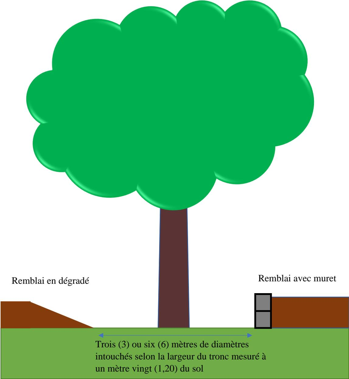
Figure 4 : Travaux de remblai – Aménagement d'un puits de protection
