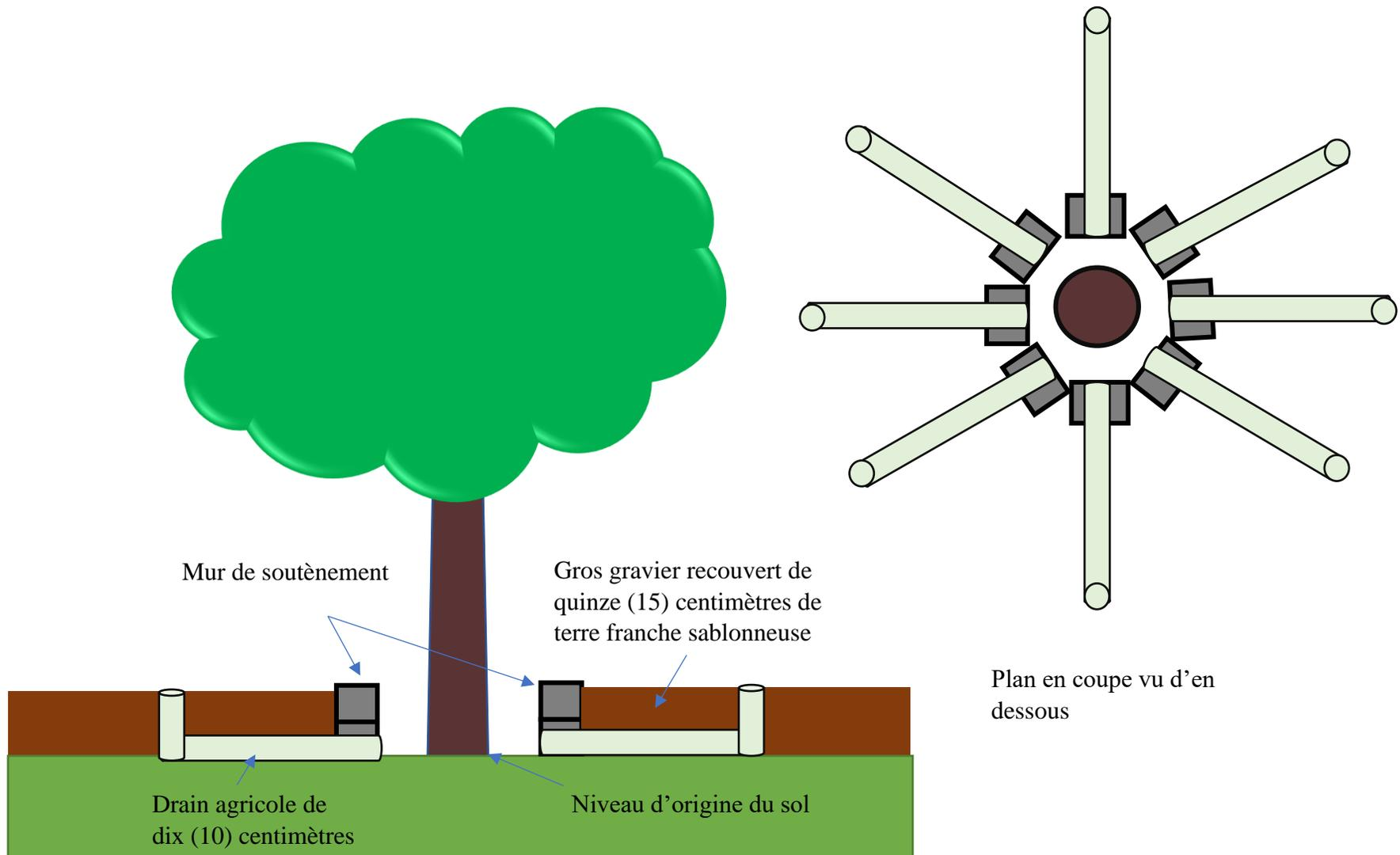
Figure 5 : Travaux de déblai – Abaissement graduel du sol
