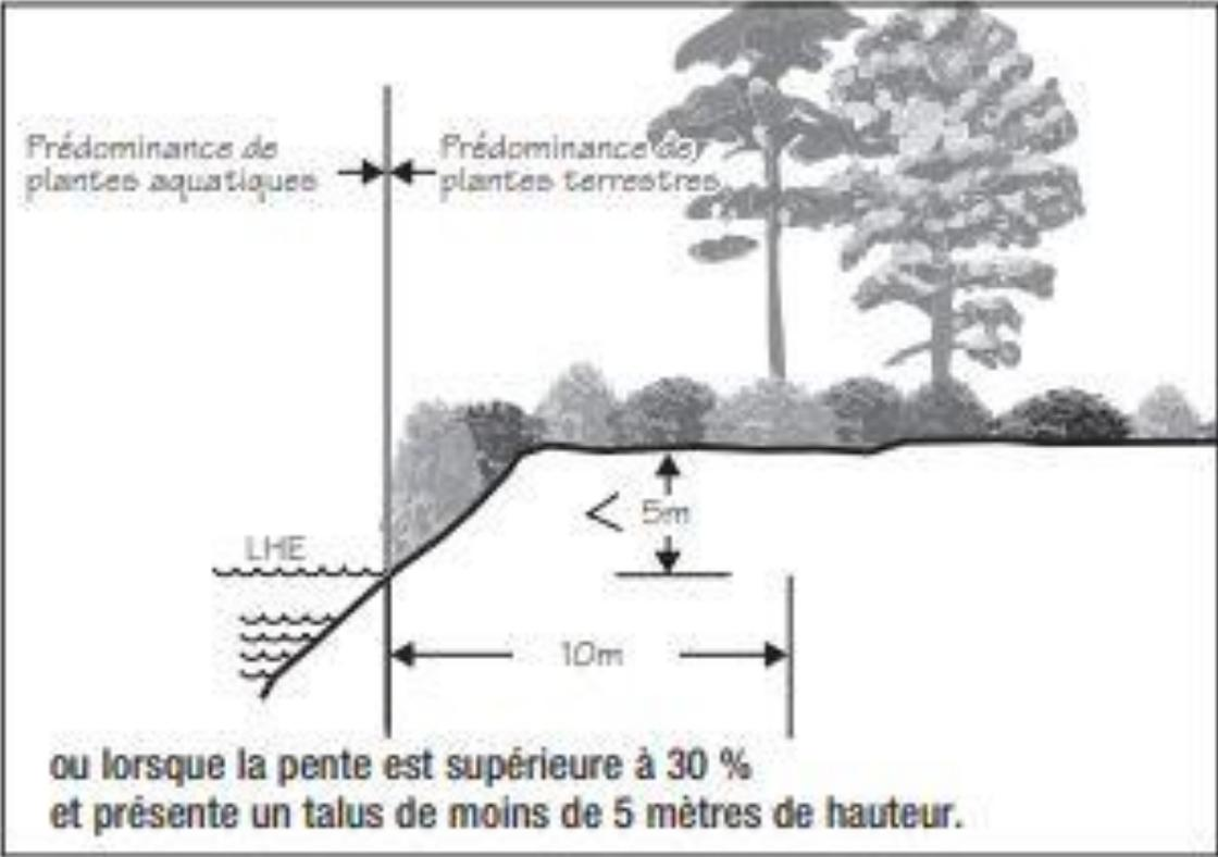
Figure 5 – Rive de 15 mètres lorsque la pente est continue et supérieure à 30%
