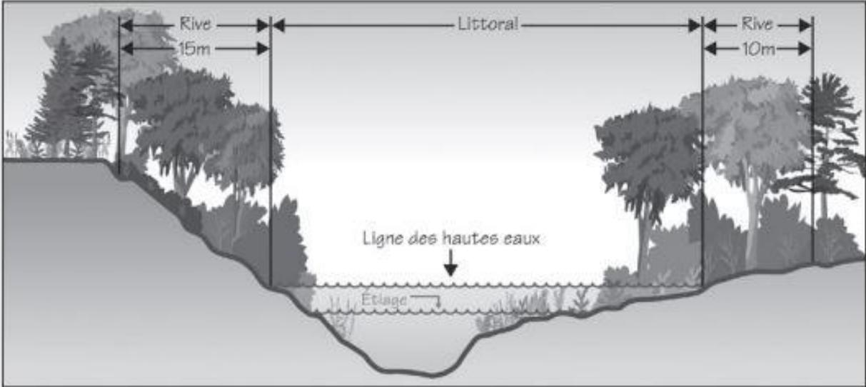
Figure 3 – Rive de 10 mètres lorsque la pente est inférieure à 30%
