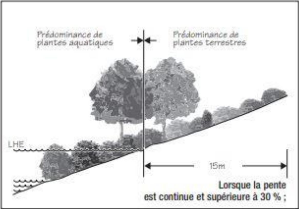
Figure 6 – Rive de 15 mètres lorsque la pente est supérieure à 30% et présente un talus de plus de 5 mètres de hauteur
